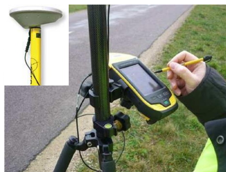
Figure 28 : Matériel utilisé pour le repérage GPS
