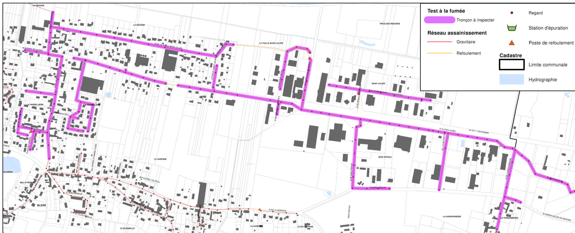
Figure 87 : Extrait du plan des propositions de tests à la fumée – Commune de Bléré
