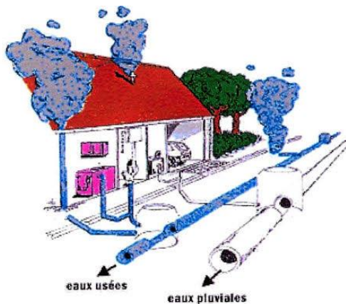
Principe de localisation des surfaces actives raccordées au réseau d'assainissement des eaux usées
