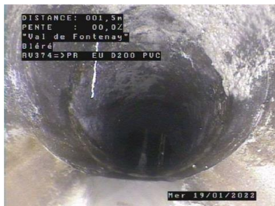
Inspection terminée avant le nœud d'arrivée – Progression impossible Vallée de Fontenay - Bléré
