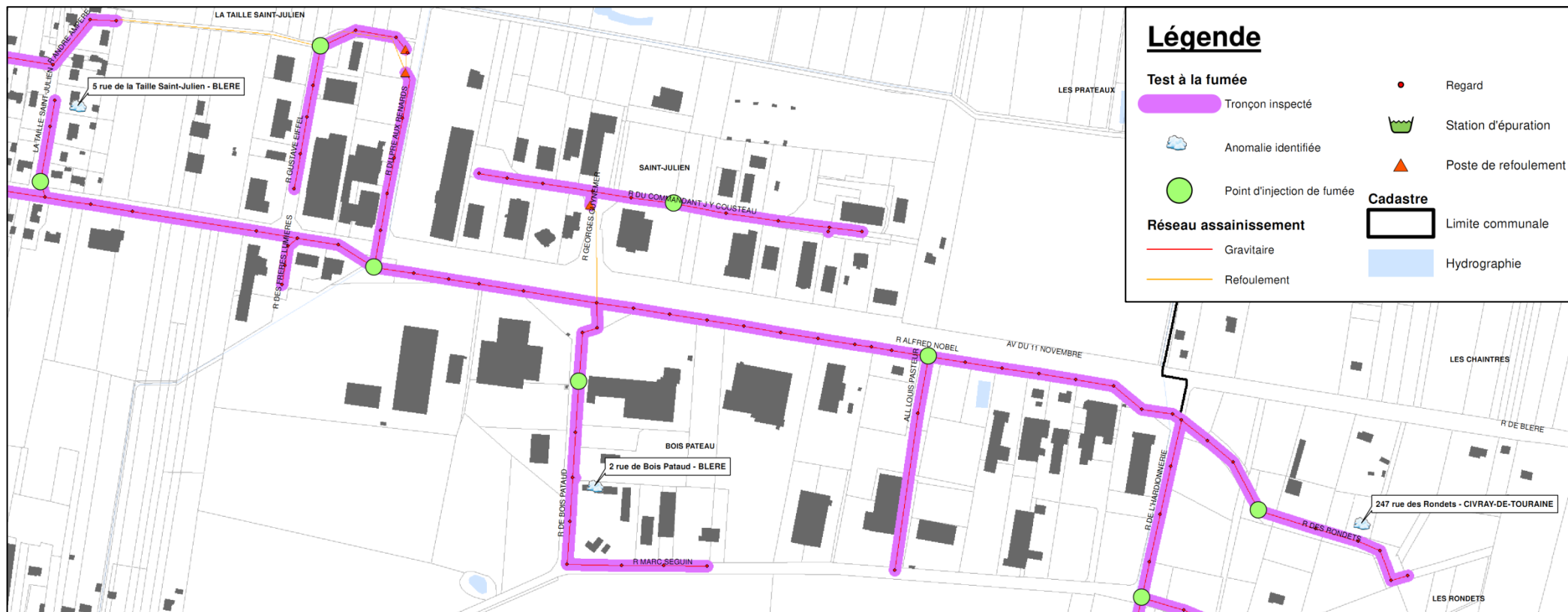
Figure 111 : Résultats des tests à la fumée réalisés
